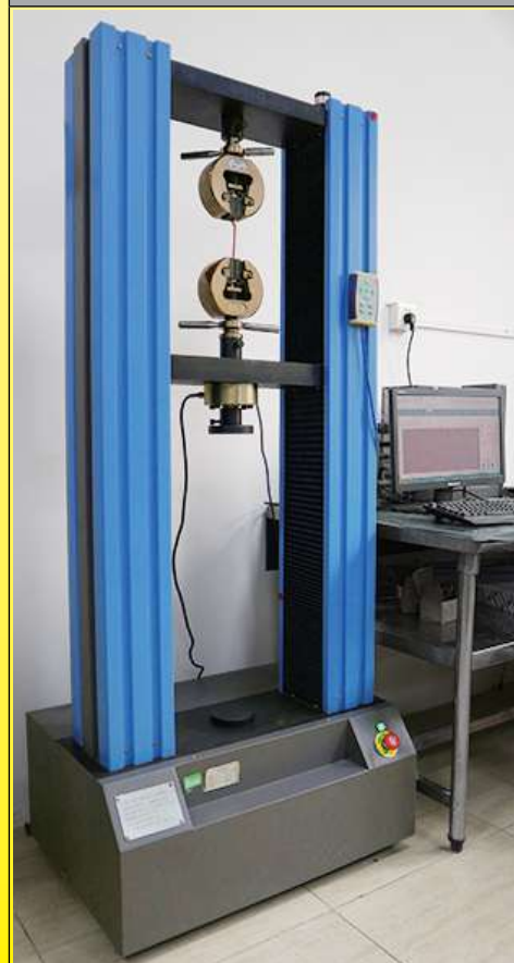
Испытательная установка для выполнения испытаний на отрыв
