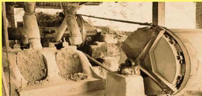
Традиционные механизмы (水碓, шуй дуй) для производства порошков, используемых для изготовления электротехнического фарфора (частная коллекция)
