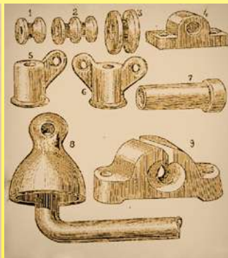
1885 год. Фарфоровые электроизоляторы (La physique moderne: l'électricité dans la maison, E. Hospitalier)
