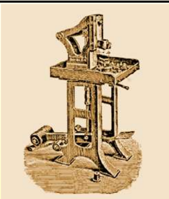
Немецкий пресс с ножным приводом для электротехнического фарфора (1905 La Céramique Industrielle, A. Granger, музей Ultimheat)
