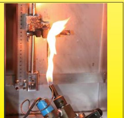
Образец во время испытания на UL94VO
