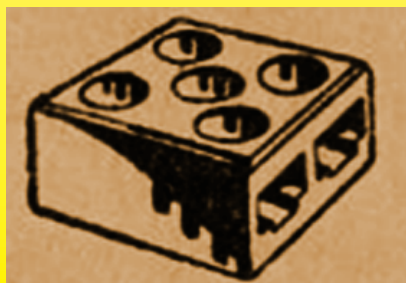
1950 г. Клеммные зажимы с крепежным отверстием (каталог Moor, музей Ultimheat)
